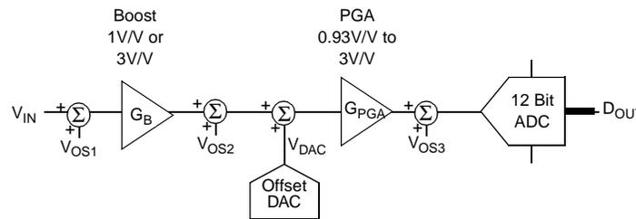
$$D_{\text{OUT}} = ((V_{\text{IN}} + V_{\text{OS1}})G_B + V_{\text{DAC}} + V_{\text{OS2}})G_{\text{PGA}} + V_{\text{OS3}})C$$
